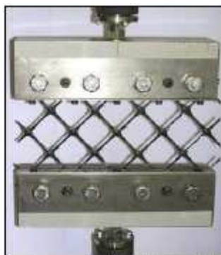
Rys. 3: Test ISO 10319 wykonywany na georuszcie dwukierunkowym
